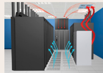
Kühleinheiten für Rechenzentren
