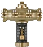
Differenzdruckregler für TA-Multi, einstellbar von 50 - 300 mbar. Werkseinstellung 100 mbar.
