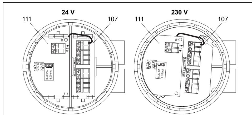
**Bild 16** Anschluss der Platine für mA-Ausgangssignal an Klemmplatine
