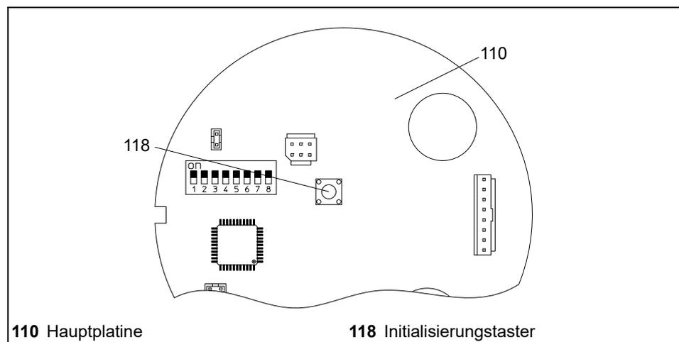
**Bild 21** Wegmesssystem initialisieren
