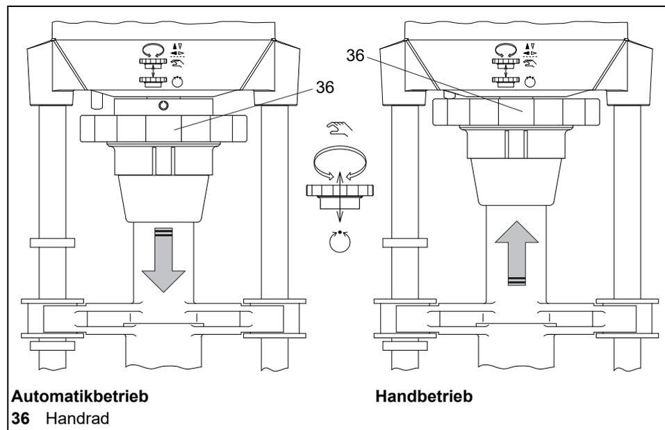
Bild 22 Automatikbetrieb wählen
