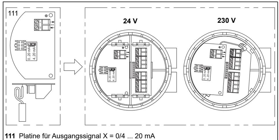
111 Platine für Ausgangssignal X = 0/4 ... 20 mA
