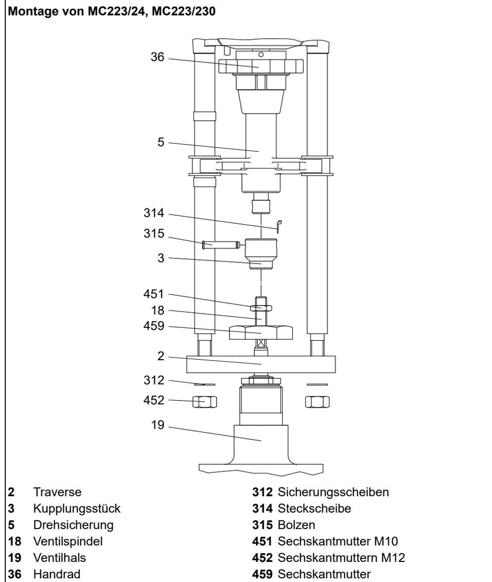
**Bild 7** Hubantrieb auf Ventil montieren
