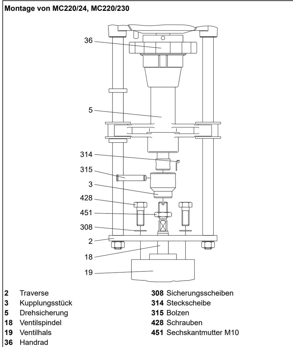
**Bild 6** Hubantrieb auf Ventil montieren
