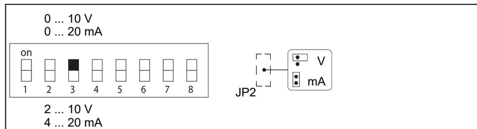
Bild 18 Eingangssignal einstellen
