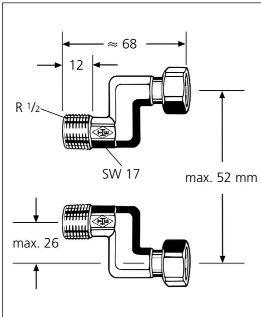
IMI HEIMEIER S-Anschluss, zeit- und kostensparende Montagehilfe beim Austausch von Heizkörpern, z. B. DIN-Radiatoren gegen Flach- oder Kompaktheizkörper.
