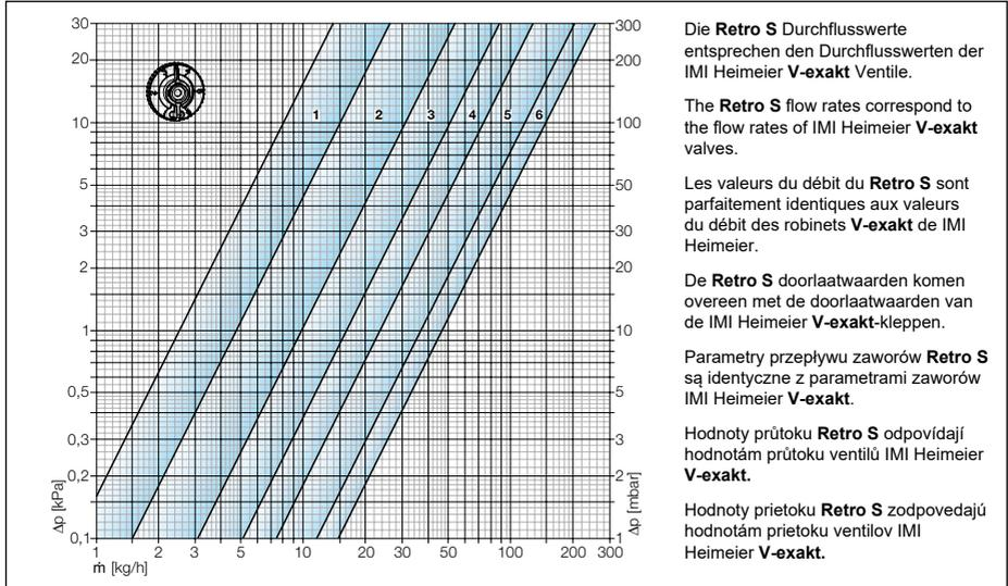
**Empfohlene Voreinstellwerte bei unterschiedlicher Heizkörperleistung, Druckverlust und Systemspreizung**
