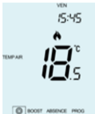
Température de la pièce
