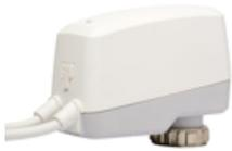
**Fonctions / caractéristiques impératives** : Paramétrage du signal de commande : 0(2)-10V, 10-(2)0V ou en demi-plage. Paramétrage de 2 débits maximum distincts (chaud / froid par exemple). Choix de la caractéristique linéaire, égal % ou égal % inversée. Enregistrement des erreurs. Duplication du paramétrage sur d'autres moteurs. Commande manuelle de secours externe. 1 entrée binaire. 1 sortie relais. Recopie de position 0(2)-10V. IP54 toute position.
