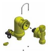
Si el espacio alrededor de la tubería en el que se debe colocar el Zeparo Turnable es exiguo, el clip que sujeta el separador y la base giratoria se puede quitar, lo que permite que la parte delantera se pueda separar. Una vez instalada la base roscada en el tubo, la parte delantera se puede volver a colocar y fijar de nuevo volviendo a insertar el clip de la parte superior.
