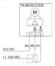
Para 230V en control 3-puntos, la dirección del actuador se puede cambiar intercambiando los cables gris y marrón.
