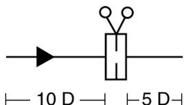
El orificio de medida debería instalarse entre dos contrabridas. Comprobar que estas contrabridas son paralelas y que las juntas están de acuerdo con el estándar dado para bridas. Comprobar también que el orificio de medida y las juntas están centradas correctamente antes de ajustar.
