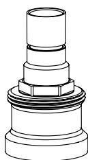
**Predĺženie vretna pre termostatickú hlavicu RTL s Multibox RTL**
