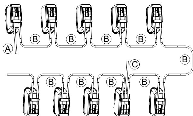
A: Za povezivanje prvog TA-Slider 160/500 BACnet ili Modbus u serijskom lancu na Bus.
