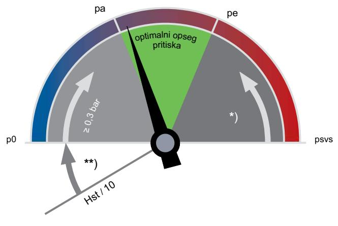
EN 12828, solarno, hlađenje:  $\geq 0,2 \text{ bar}$
