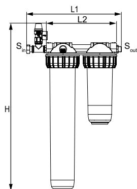
**Jedinica za demineralizaciju sa zidnim nosačem i 25 µm filterom**
