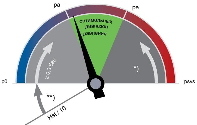
$**)$ EN 12828, гелиосистемы, Охлаждение:  $\geq 0,2$  бар $*)$ EN 12828:  $\geq p_{svs} \cdot 0,1 \geq 0,5$  бар
