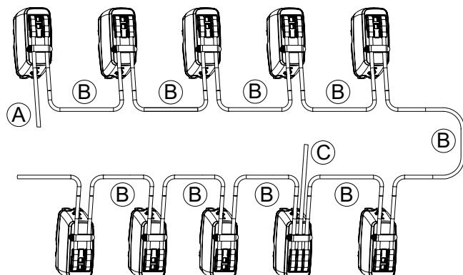
A: Pentru conectarea primului TA-Slider 160/500 BACnet sau Modbus la rețeaua de comunicație Bus.
