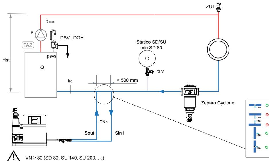
Valvole di sfogo **Zeparo ZUT** o **ZUP** in ognuno dei punti più elevati, per sfogare l'aria durante le fasi di riempimento o svuotamento.
