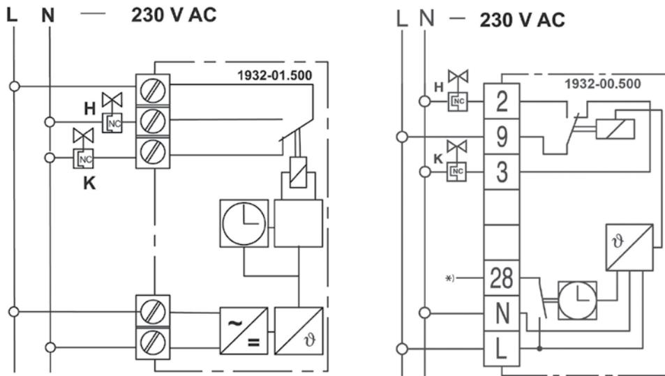
\*) Hinweis: An Klemme 28 (abgehende Betriebsspannungs-Phase bewirkt Betriebsart Absenken) können weitere Raumthermostate mit Temperaturabsenkenfunktion angeschlossen werden.
