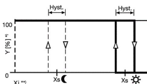
Verlauf der Einschaltdauer (Tastverhältnis) in Abhängigkeit von der Temperatur.
