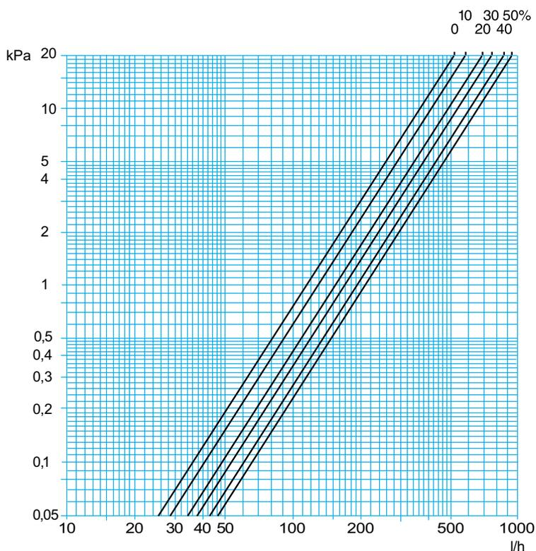
Einstellung ab Werk 50% zum Heizkörper.
