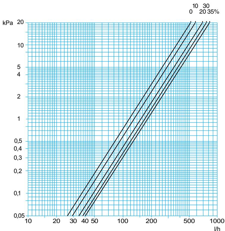
Einstellung ab Werk 35% zum Heizkörper.
