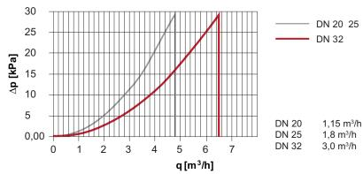
Zeparo DN 20 – DN 32 doivent être utilisés pour un débit ≤ qN.
