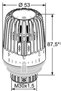
**Avec dispositif anti-vol par 2 vis**
