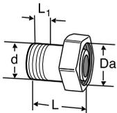
**Douille droite avec écrou**
