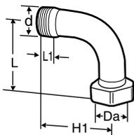
**Raccord coudé avec écrou**
