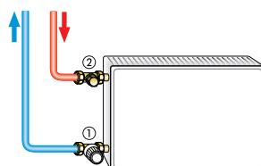
1. Termostatski ventil za suprotni smjer strujanja
