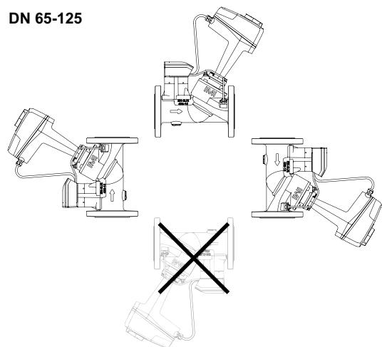
**Nota:** É necessário espaço livre acima do atuador/poço de sensor de temperatura para fácil montagem/desmontagem.
