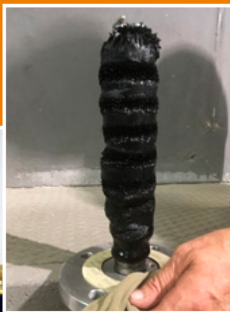
Aimant Ferro-cleaner après 1 an d'utilisation
