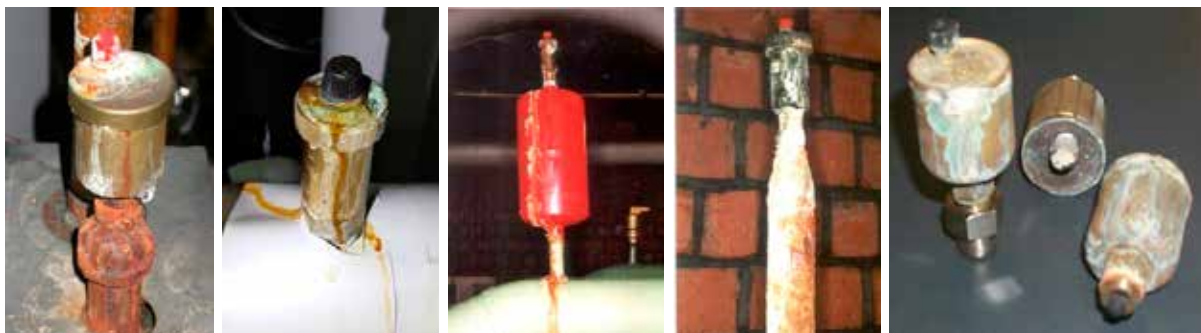
Primer nekvalitetnih odzračnih ventila, koji ubrzo počinju da cure zbog svoje neispravne konstrukcije
