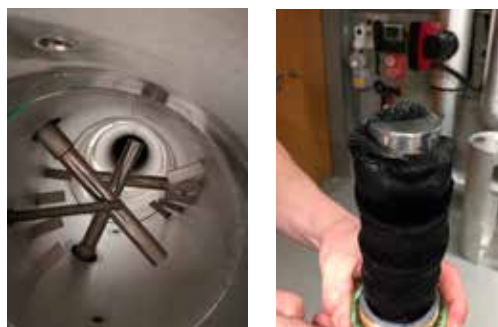
Unutrašnji pogled na Ferro-Cleaner većih dimenzija. Primer Efikasnost Ferro-Cleaner-a
