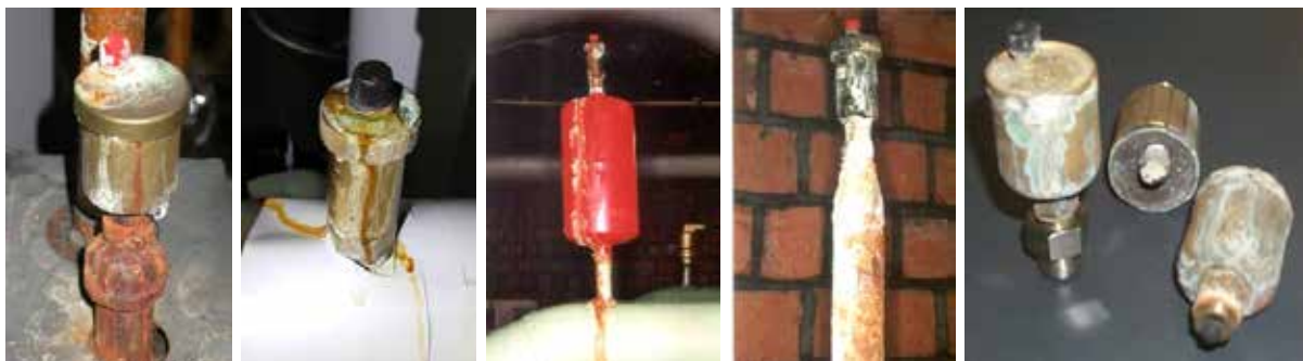
Voorbeeld van ontlueters van slechte kwaliteit, die snel zullen gaan lekken door hun gebrekkige constructie
