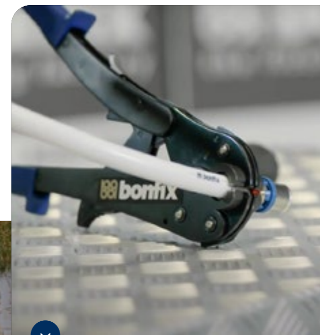
Hier is gebruik gemaakt van het Bonfix Alu-pers systeem.
