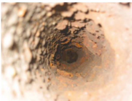
Egy korrodált, NA 100-as acélcsővezeték belső felülete
