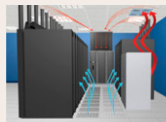
Chladicí jednotky pro místnosti s výpočetní technikou
