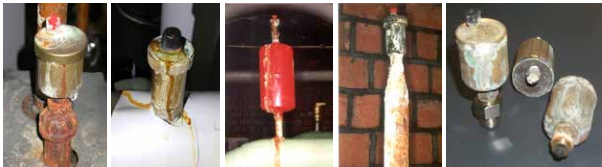
Voorbeeld van ontluchters van slechte kwaliteit, die snel zullen gaan lekken door hun gebrekkige constructie
